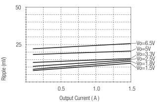
Ripple Vs Load (Vin=Max)
